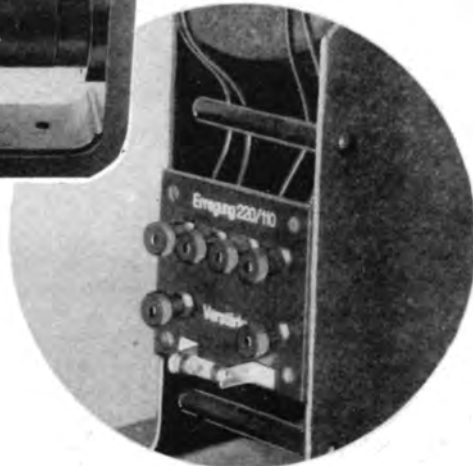
Bei Fremderregung des Dynamischen sieht man oft Umschaltbarkeit 110/220 Volt vor, sowie — sehr zweckmäßig! — eine Sicherung für die Triebspule, die bei falschem Anschluß durchbrennt.
